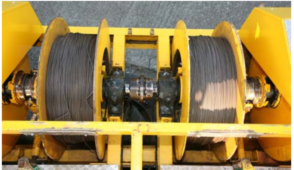
7.4 Twee trommels van een lier waarop de kabel is gewonden
