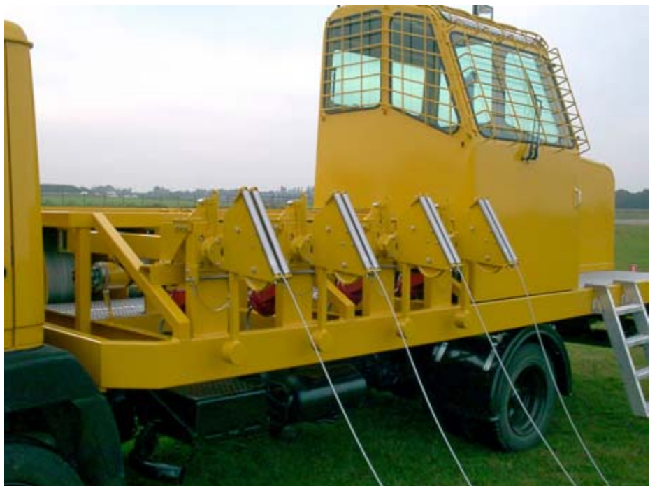
7.5 Kabelgeleiding voor de 4 kabels van een Busio-lier
