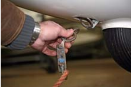
7.11 De kabel met breukstuk wordt bevestigd aan de sleephaak van het zweefvliegtuig, in dit geval een ASK-21 tweezitter.
